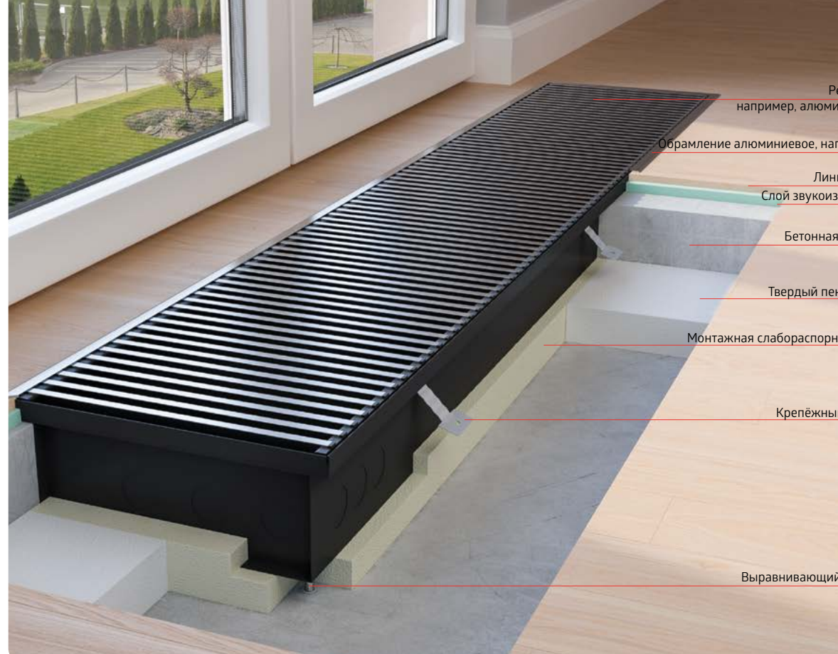
Пример монтажа неглубокого внутрипольного конвектора
